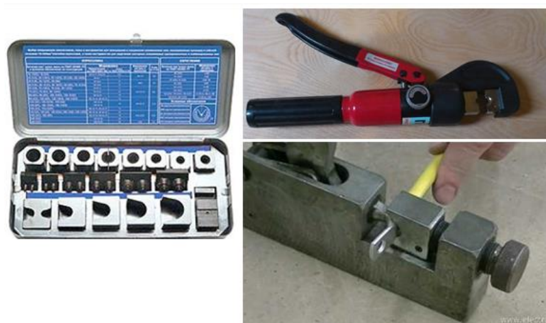
Рисунок 34 – Инструменты и приспособления для опрессовки алюминиевых и медных проводов с помощью гидравлических пресс-клещей
