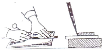
Рисунок 8 – Нанесение рисок кернером
